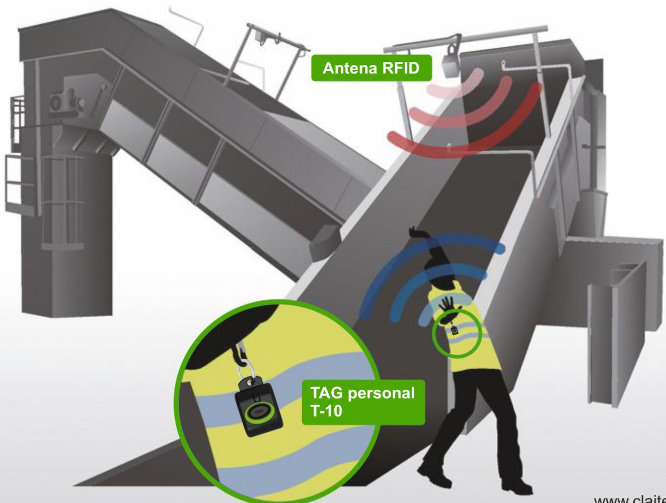
Claitec ha realizado la instalación de la solución de áreas peligrosas en **más de 100 plantas de recuperación**, protegiendo a todos los trabajadores que operan en **áreas peligrosas**, previniendo de accidentes graves por parada de la máquina automática.
